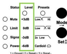
Durch einmaliges Drücken der Mode-Taste gelangen Sie in den Levelmodus, der Lautstärkeanpassungen in 3 dB Schritten erlaubt. Es stehen vier verschiedene Werte +3 dB, 0 dB (Standard), -3 dB und -6 dB zur Verfügung. Die Einstellung erfolgt durch den Taster „Set“. Die darüber befindliche grüne LED gibt Auskunft darüber, in welchem Modus Sie sich befinden, wobei die vier senkrecht angeordneten LED's (nun grün leuchtend) den jeweils eingestellten Wert angeben.
