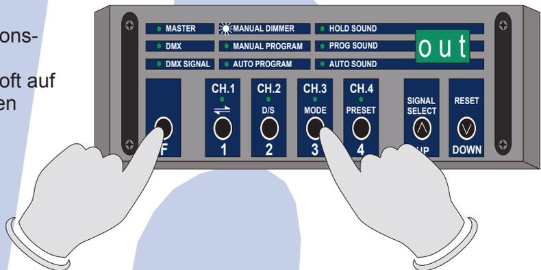
Jetzt können Sie Alle 4 Kanäle einzeln nach Lichtbedarf dimmen oder switchen (**A-1**). Drücken Sie die **CH-1** Taste und das grüne LED fängt an zu blinken. Jetzt können Sie mittels die **UP** und **DOWN** Tasten die gewünschte Lichtstärke einstellen. Drücken Sie jetzt die **CH-2**, **CH-3** oder **CH-4** Taste und stellen Sie mittels die **UP** und **DOWN** Taste auch hier die gewünschte Lichtstärke ein.
